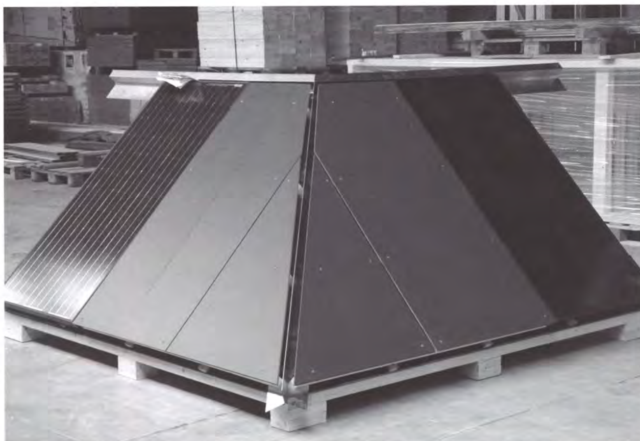
Mock-up med tagmaterialer og solcelletyper. Foto: Energi+
